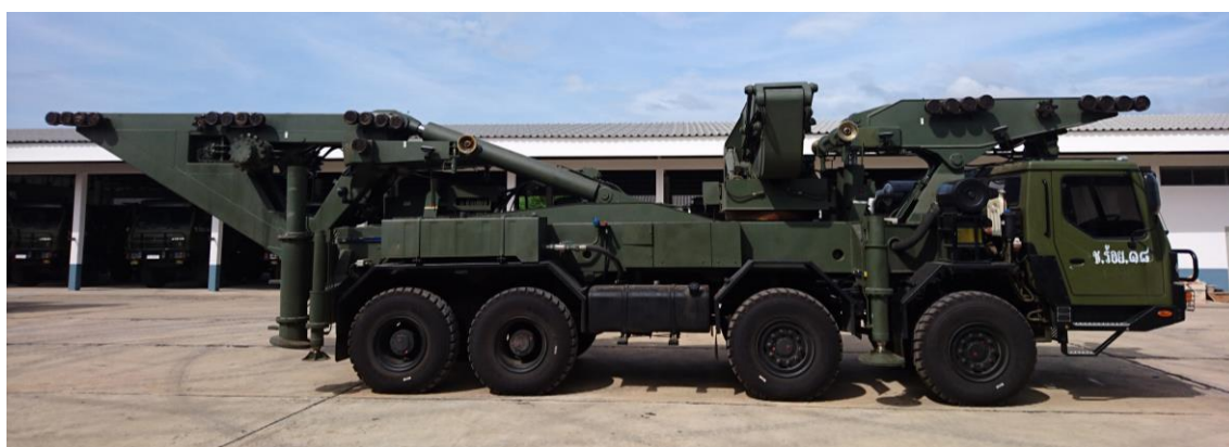
รถประกอบสร้างและวางสะพาน
