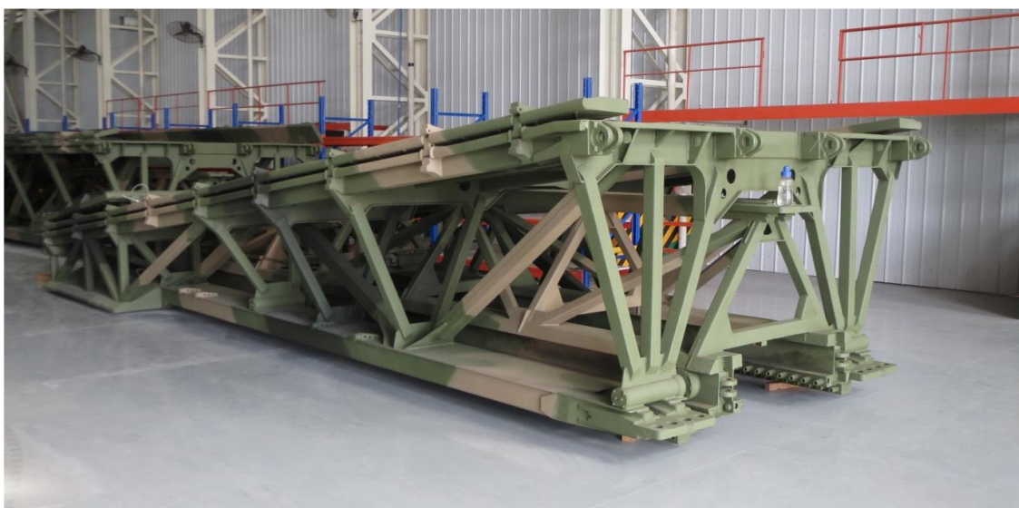
สะพานทอดปลายลาด
