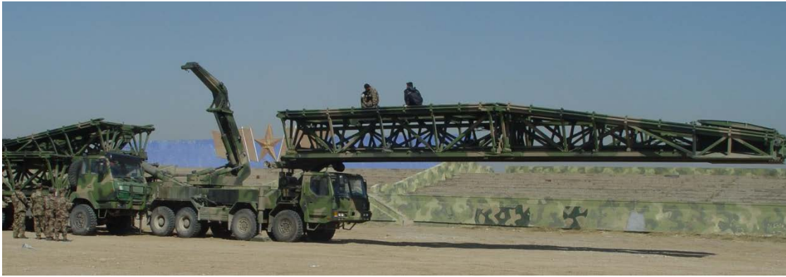
รูป 3-15 การต่อและดันออกของช่วงสะพานที่สาม
