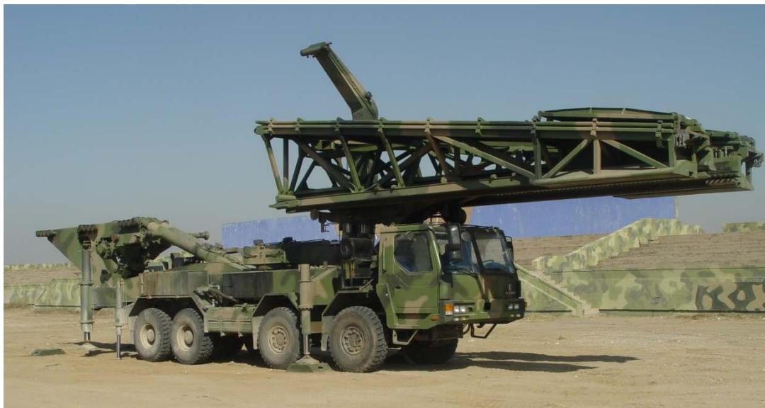
รูป 3-7 การดันช่วงปลายสะพานออกไปทางด้านหน้า
