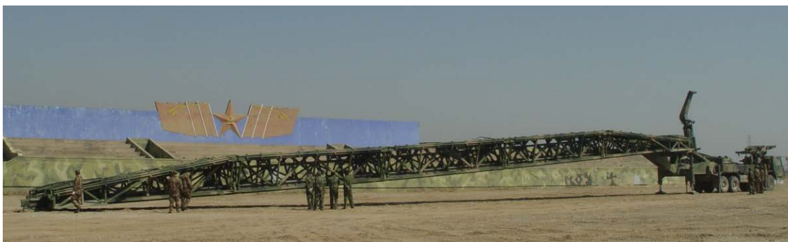
รูป 3-25 ช่วงสะพานจะถูกดันไปตามแท่งนำ
