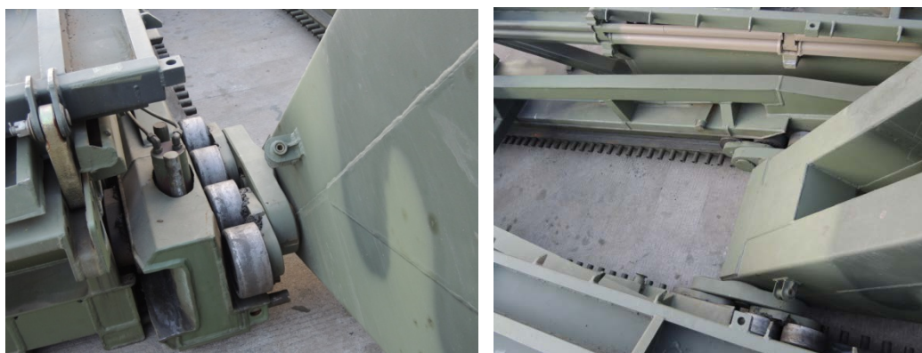
รูป 3-31 ลดระดับโครงวางและดันโครงเคลื่อนที่ออก
