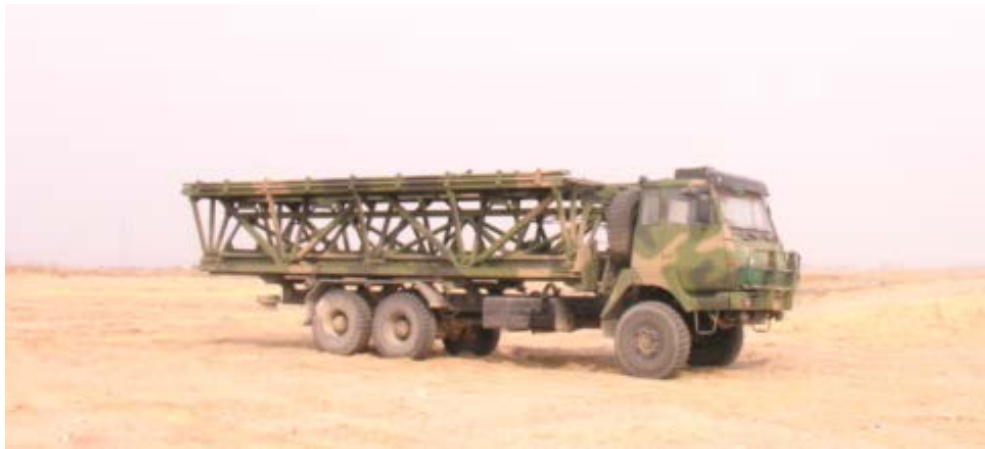
รูป 1-2 รถขนส่งสะพาน(พร้อมตัวสะพาน)
