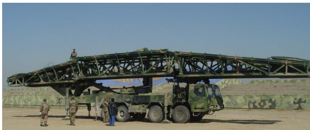
รูป 3-13 การยกสะพานช่วงที่สาม
