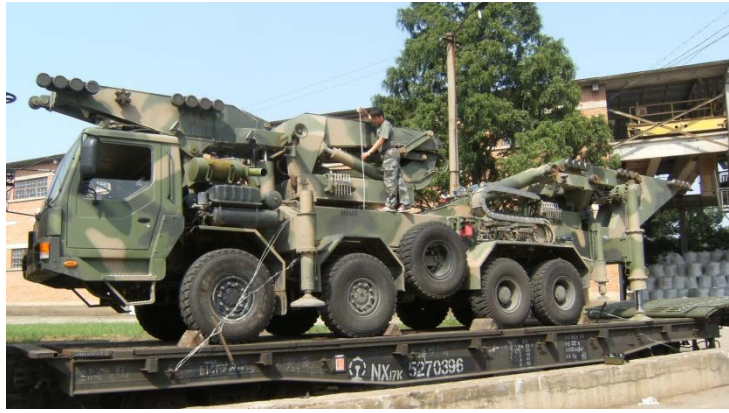
รูป 6-1 การเคลื่อนย้ายทางรถไฟของรถวางสะพาน
